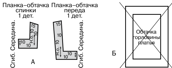
Рис. 9. Варианты выкроек обтачек горловины платья: А — правильное; Б — неправильное.
